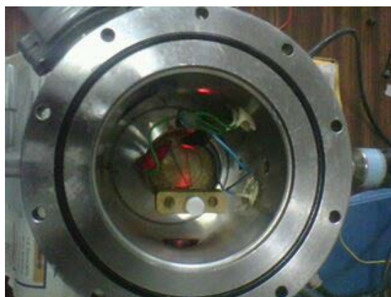
Figura 2.8.1 Criostato con un fragmento de la muestra ya colocado.
