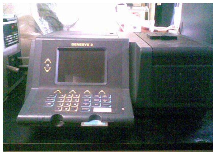
Figura 2.3.2 Espectrofotómetro Genesys 2, con el cual se midió la absorción óptica.
