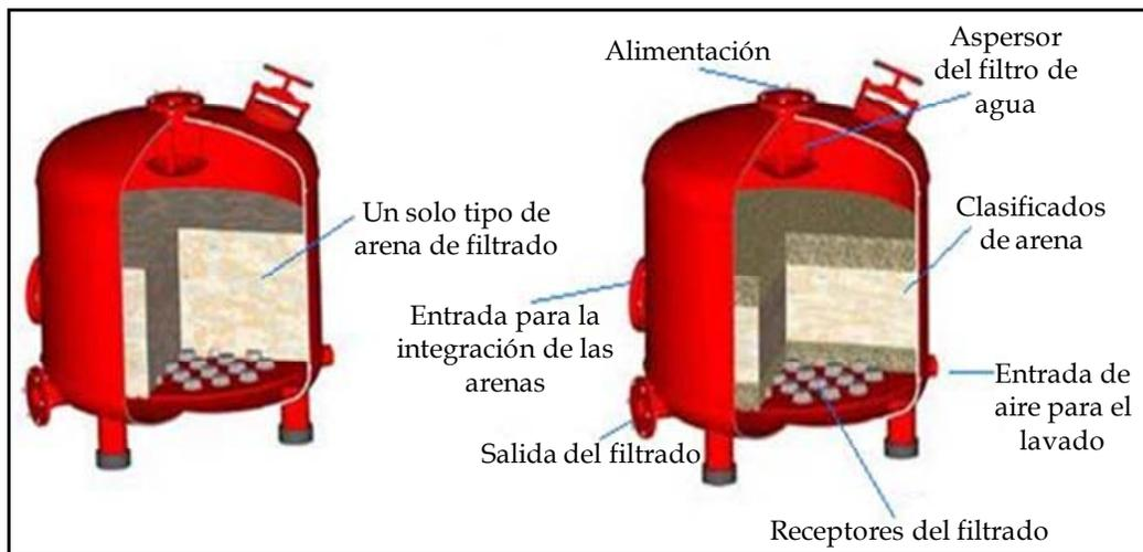
Figura A.17 Esquema simplificado de los filtros a presión. (Izq.) filtro de arena y (der.) filtro con diferentes medios (El Regante,2010).
