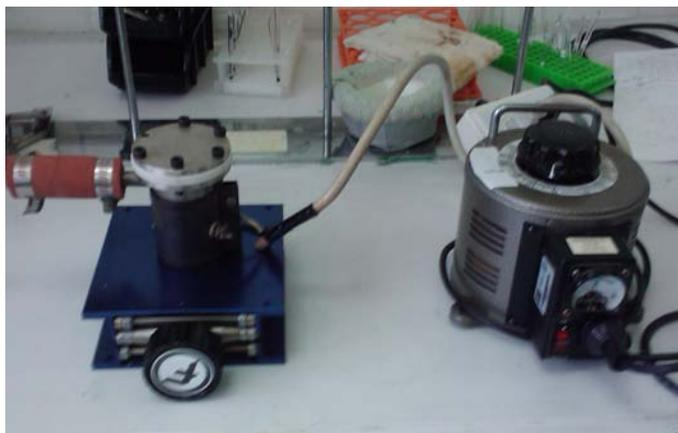
**Figura 3.4** – Reactor de acero inoxidable y resistencia empleada. Se empleó un auto-transformador (*variac*) para inducir el voltaje en la resistencia. La válvula a la izquierda del reactor se utilizó para evacuarlo.
