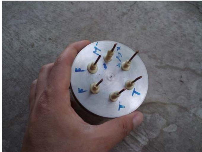
**Figura 3.3** – Atravesadores de potencia insertados sobre una pieza de acero inoxidable, las marcas indican las conexiones empleadas: filamento (F), termopar (T), mecanismo de bloqueo (M) y su polaridad.
