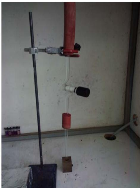
**Figura 3.6** – Válvula empleada para equilibrar presiones en el proceso de sellado
