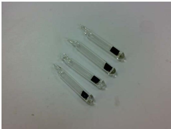
**Figura 3.5** – Ampolletas selladas al vacío con las muestras de  $C_{60}$  y el compuesto (DAN)
