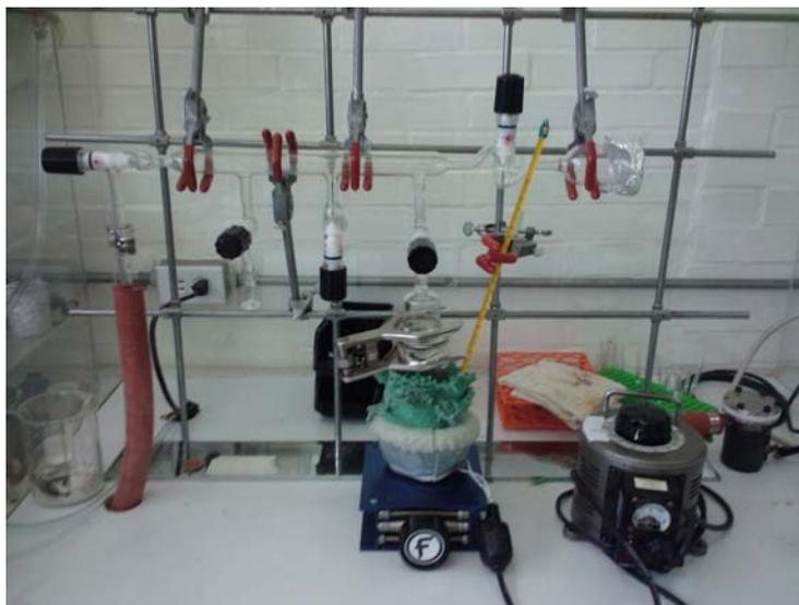
**Figura 4.4** – Línea de vacío empleada para deshumidificar la muestra
