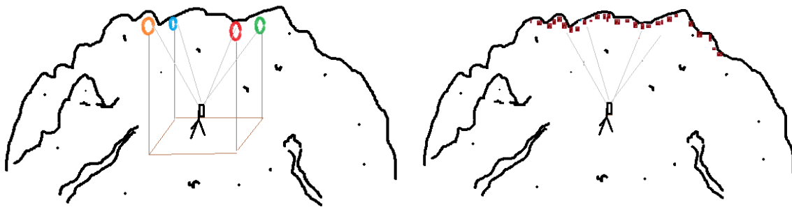
Figura 16. Esquema que indica cómo se realizaron los conteos de murciélagos al interior de la cueva. La figura al centro representa la cámara montada en un tripié, los círculos de colores globos y los cuadros cafés murciélagos.
