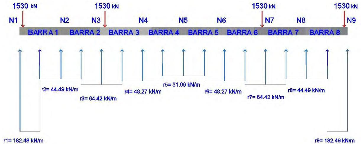
Figura III.10. Diagrama de reacciones en el suelo a lo largo del eje de la retícula, caso 2.
