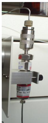
Fig. 2.7.- Columna analítica de 5cm de longitud marca Phenomenex conectada al cromatógrafo de líquidos Knauer.
