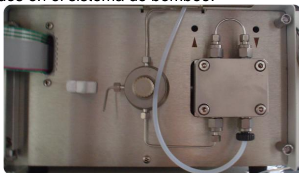
Fig. 2.4.- Sistema de bombeo de pistón recíprocante del cromatógrafo de líquidos Knauer.
