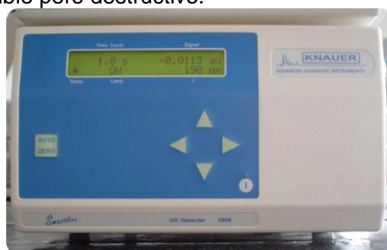
Fig. 2.8.- Detector UV-Visible del cromatógrafo de líquidos Knauer.
