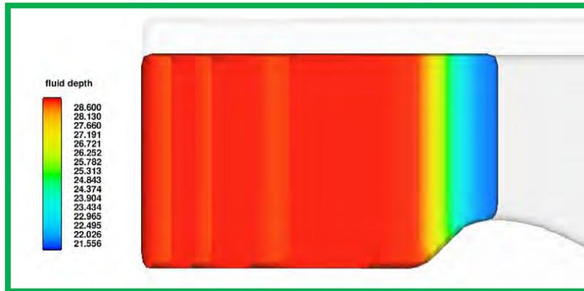
Figura 4.15 Condiciones Iniciales para Modelación del Gasto de 5 037 m<sup>3</sup>/s
