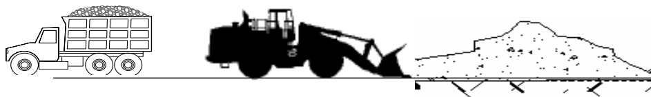
Figura 30.- Esquema de retiro de rezaga
