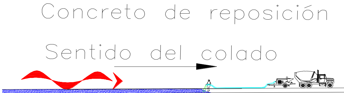
Figura 61.- Esquema de colocación de concreto de reposición
