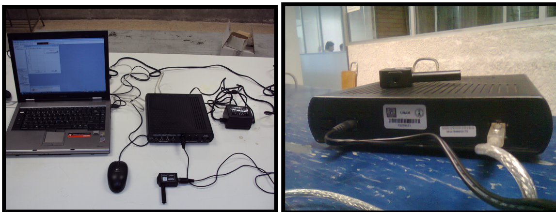
Figura 18: Conexión de interfaz en la computadora y el sensor de sonido
