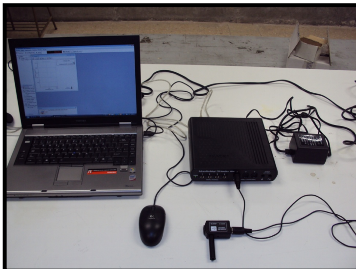
Figura 42: Conexión de interfaz en la computadora y el sensor de sonido
