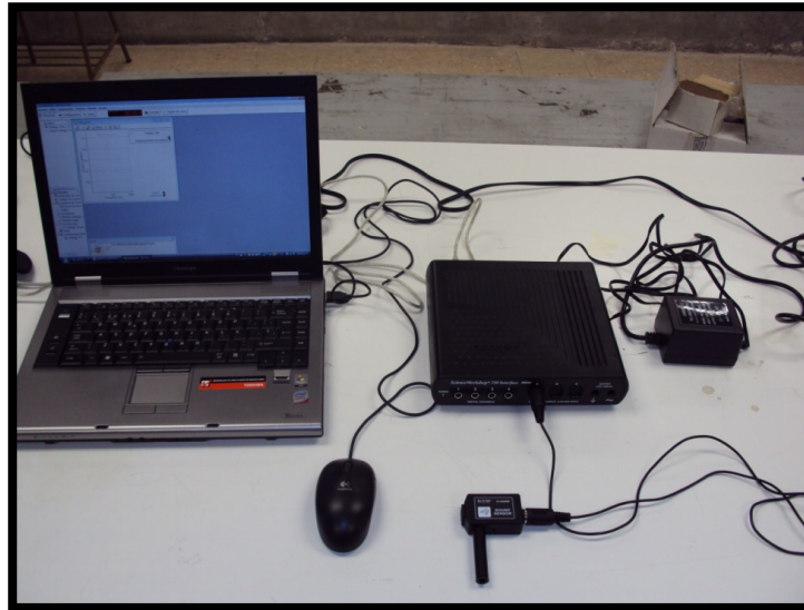
Figura 28: Conexión de interfaz en la computadora y el sensor de sonido
