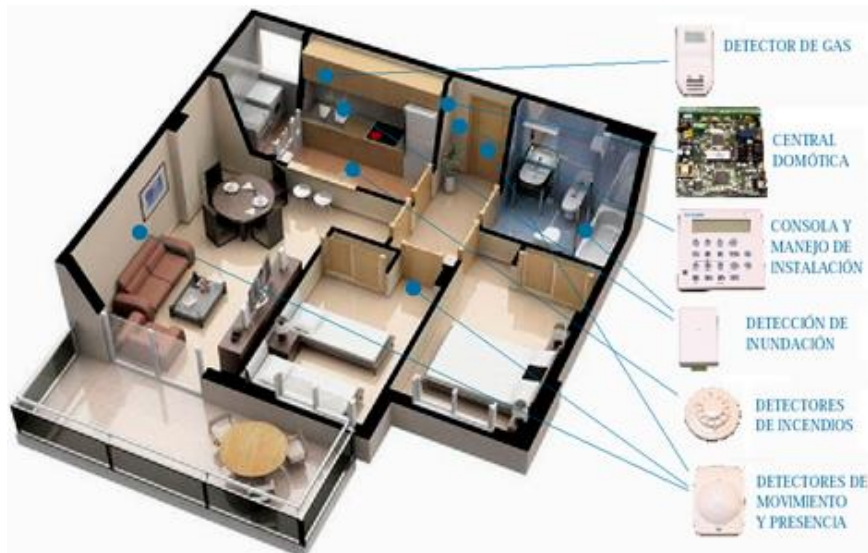
Fig. 1.1 Ejemplo de distribución de componentes de seguridad. [2]
