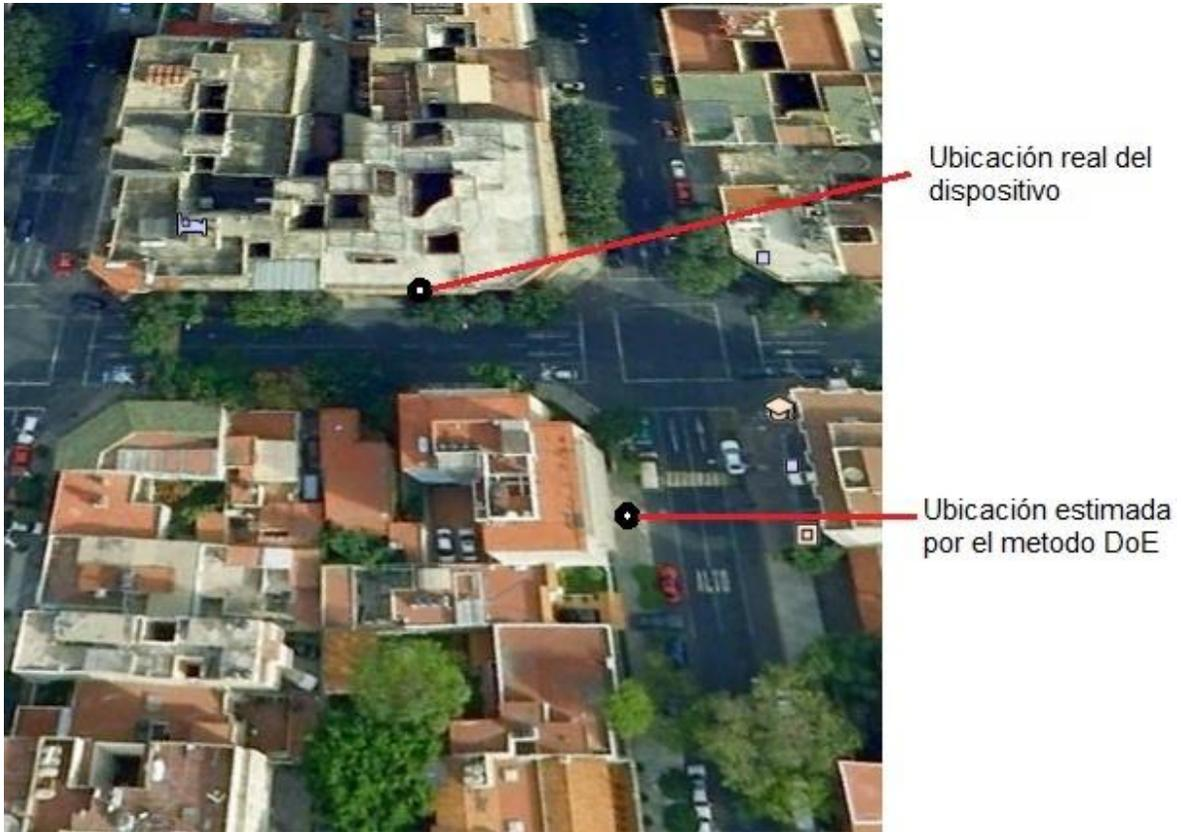
Figura 4.9 Comparación de la ubicación real y la ubicación estimada por el método DoE
