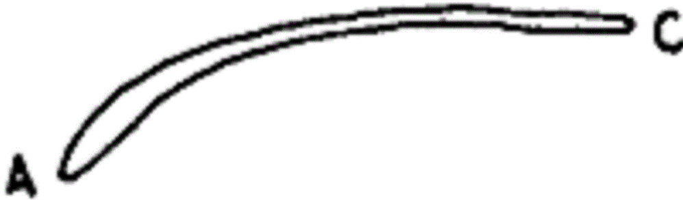
Figura 2.13. Carta dinamométrica que representa Candado de Gas.
