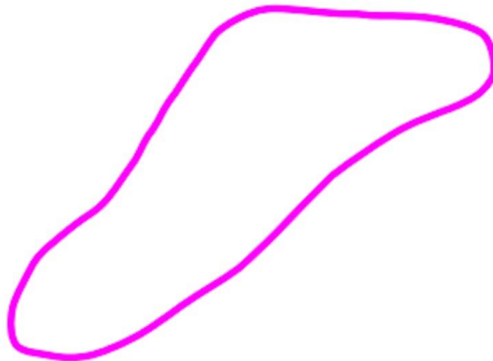
Figura 2.15. Carta dinamométrica que representa Varillas Partidas.
