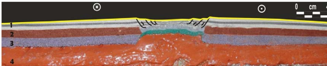
Figura 5.11. Corte final experimento 11, se muestra una sección perpendicular al eje del rift , este corte representa la fase final de la deformación, 1 representa la corteza superior quebradiza, 2 la corteza inferior dúctil, 3 el manto litosférico y todo se encuentra flotando en 4 una astenósfera. La zona central adelgazada, también está compuesta de tres capas de diferentes colores y son relativamente más débiles. El bloque de la izquierda es el móvil y el de la derecha es fijo.
