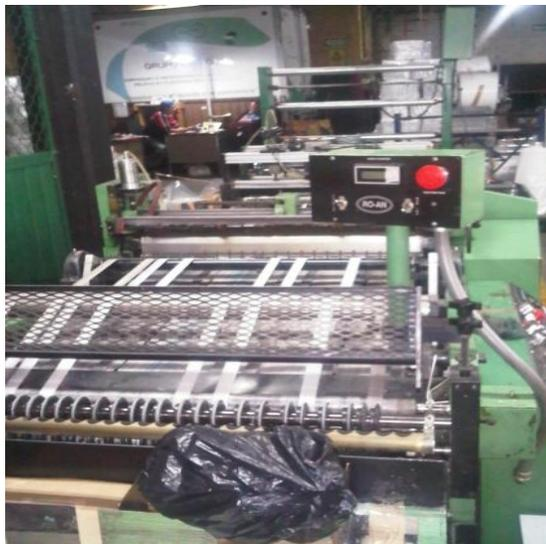
**Fig. 1.10** Máquina Selladora lateral
