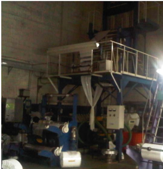
**Fig. 1.3** Máquina Extrusora Carnevalli
