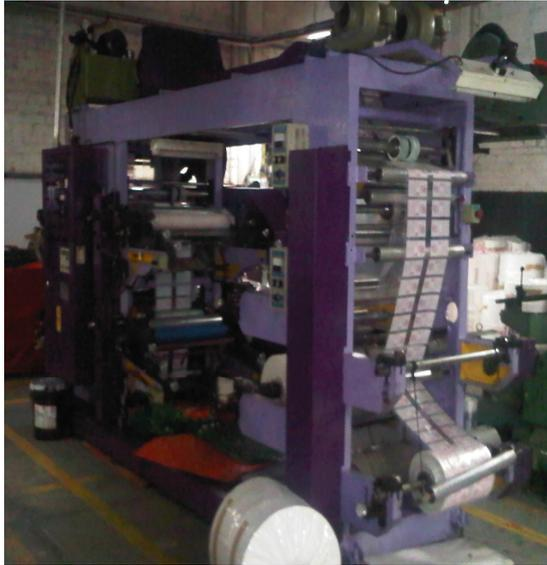
**Fig. 1.6** Máquina Flexográfica o impresora Comexi
