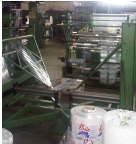
**Fig. 1.15** Máquina Selladora lateral RO-AN
