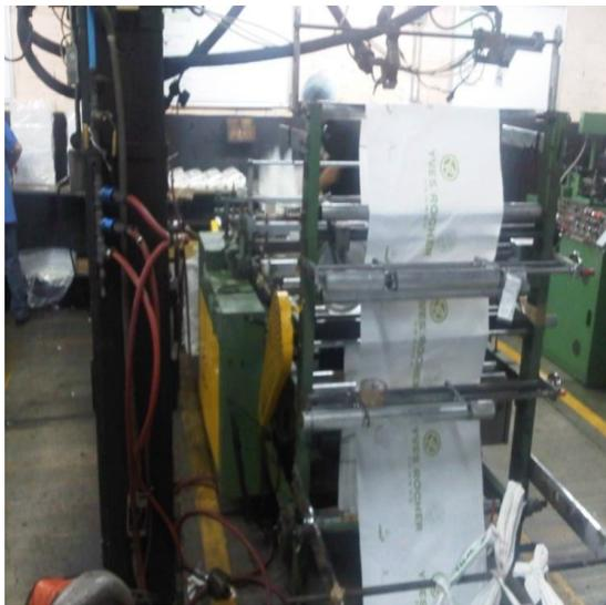
**Fig. 1.11** Máquina Selladora lateral
