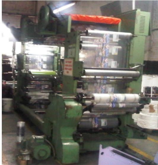
**Fig. 1.4** Máquina Flexográfica o impresora Matila
