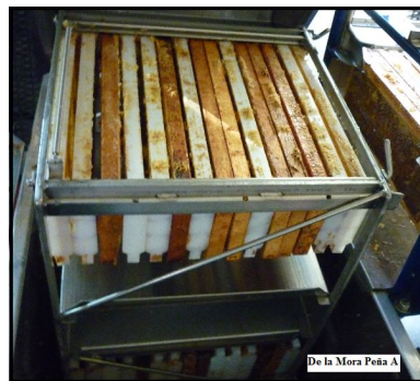
Figura 28. Extractor motorizado cuadrangular
