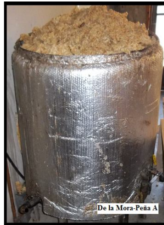
Figura 34. Barril fundidor de cera
