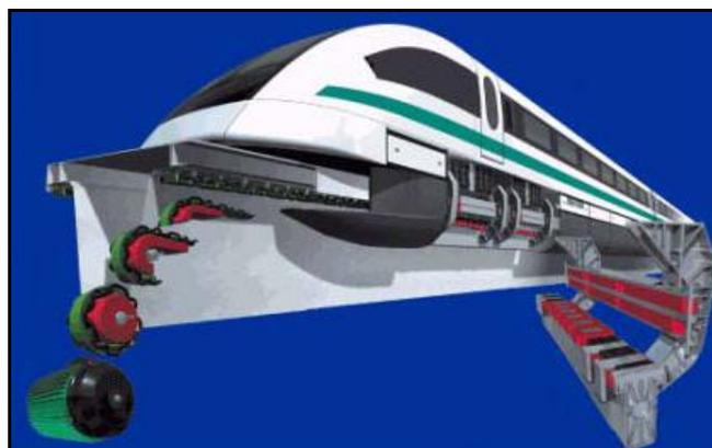
Figura 2.21 Corte de vía de un tren Maglev
