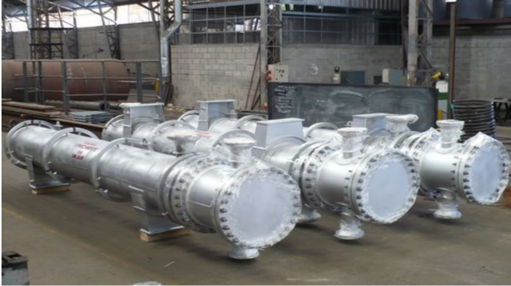
Figura 1. Intercambiador de calor de carcasa y tubo.
