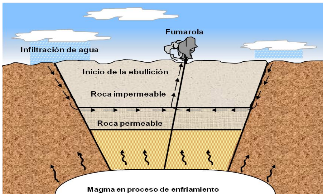
Figura 1.1. Esquema de un sistema geotérmico
