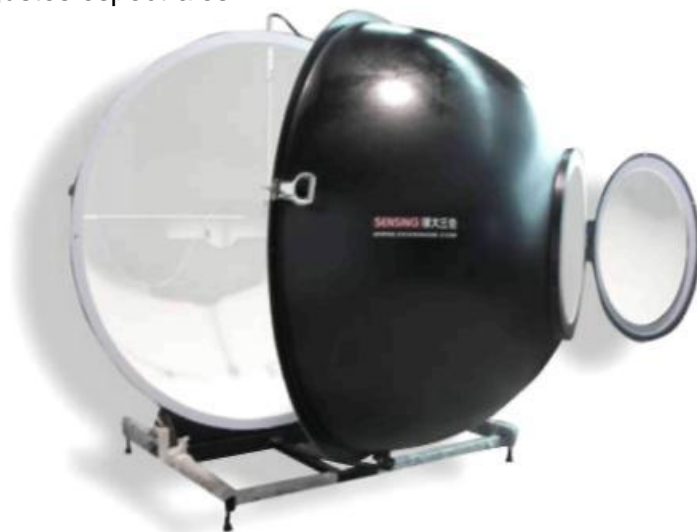
Figura 5.4 Esfera integradora con geometría 4\pi y 2\pi
