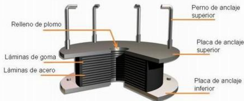
Figura 5.17 Componentes básicos de un aislador elastomérico
