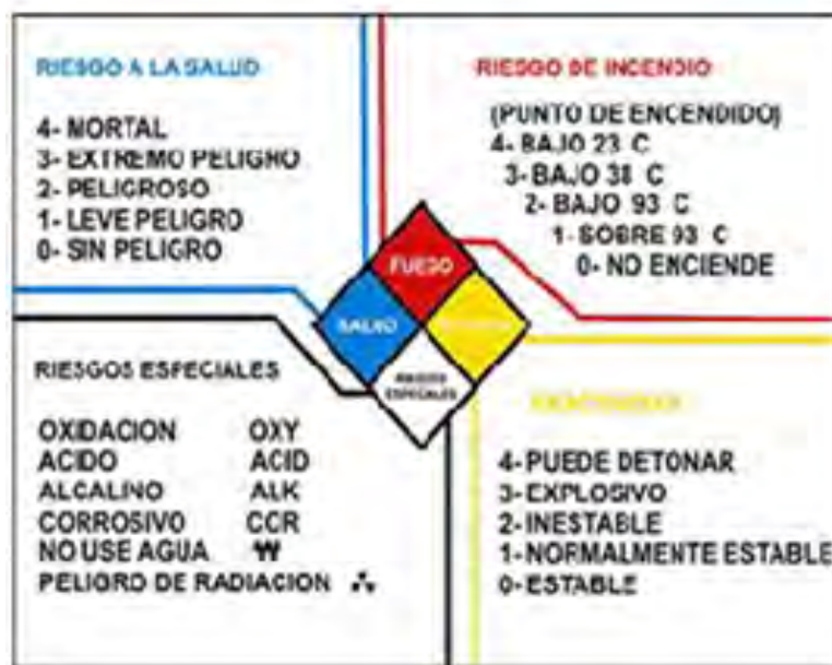
Figura 1.3. Pictogramas utilizados para identificar riesgos en un laboratorio químico y el diagrama del rombo de colores.
