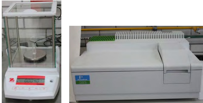
Figura 3.2. En las siguientes imágenes se muestra el espectrofotómetro UV-Vis spectrometer LAMBDA 25 de la marca Perkin Elmer, y la balanza analítica OHAUS 214 en la cual se peso la arcilla
