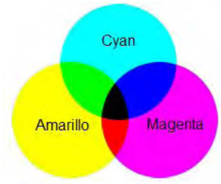
Figura 1.4 Diagrama de la mezcla de sustancias del color que absorben la luz de denominado color sustractivo o CMYK (Hutton-Jamieson, 1991).
