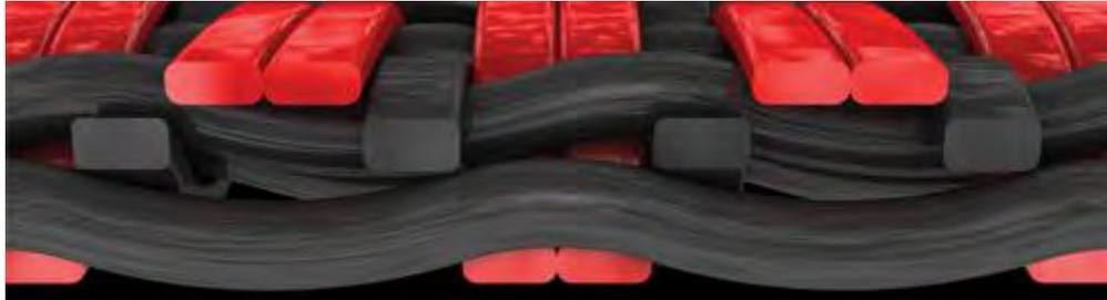
Figura 9 Estructura tridimensional de una lona espiral una vez termofijada.
