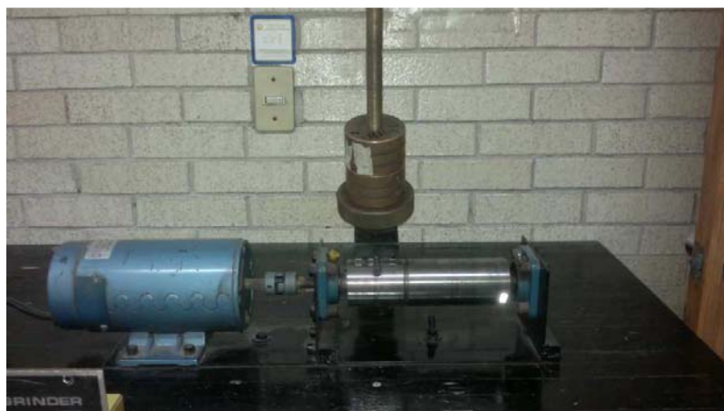
Figura 3.4 Equipo de desgaste, una variación del equipo Pin on disk.
