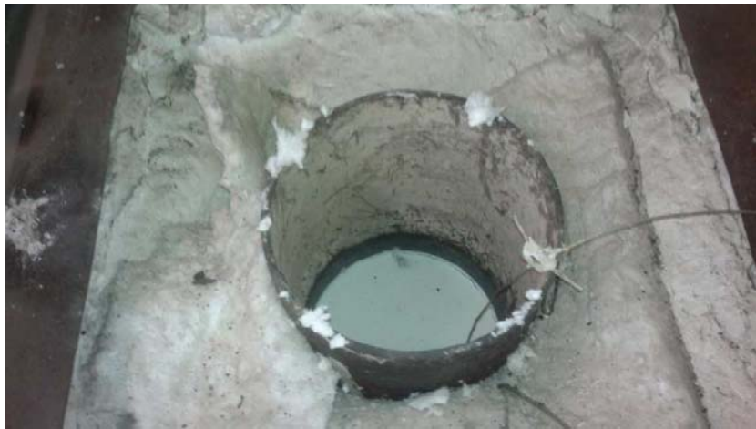
Figura 3.7 Crisol y baño de sales (Nitrito y Nitrato de sodio) del horno eléctrico de resistencia.
