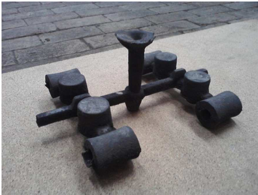
Figura 1.5 Pieza prototipo fabricada con hierro dúctil con carburos.
