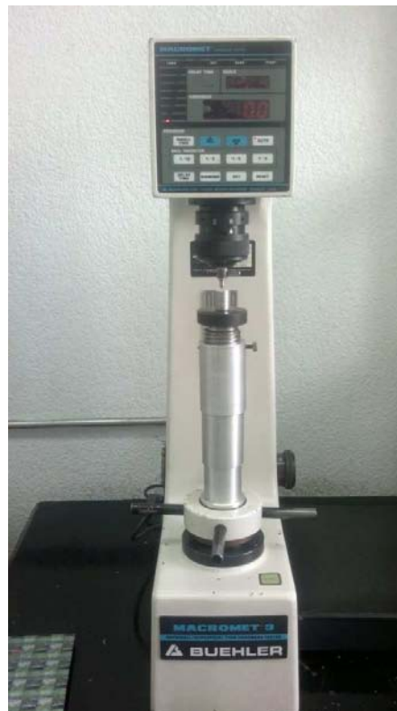
Figura 3.2 Durómetro Macromet 3 (Hardness Tester) BUEHLER.
