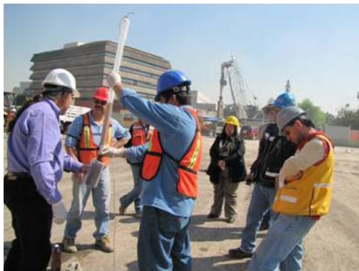
Figura No. 24 Toma de muestra de agua subterránea mediante bailer
