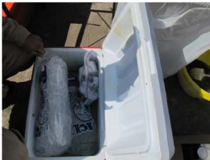
Figura No. 23 Conservación de muestras para su transportación al laboratorio
