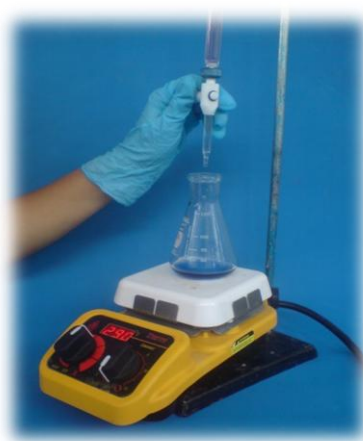
Figura 23. Titulación de soluciones Fehling.
