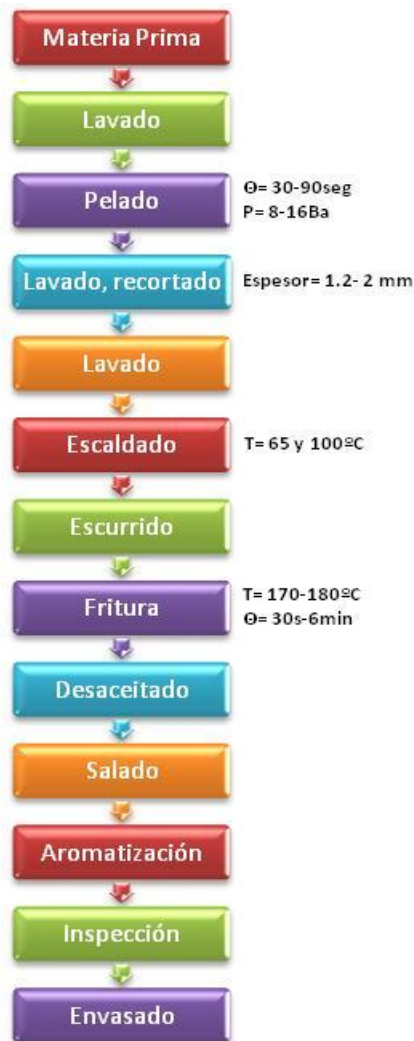
Figura 10. Etapas sucesivas de la transformación de papas fritas tipo “chips”.
