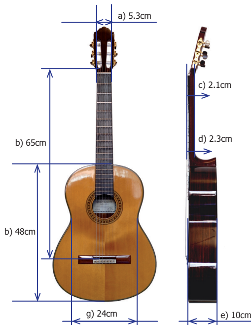
Esquema 2 Medidas de la guitarra
