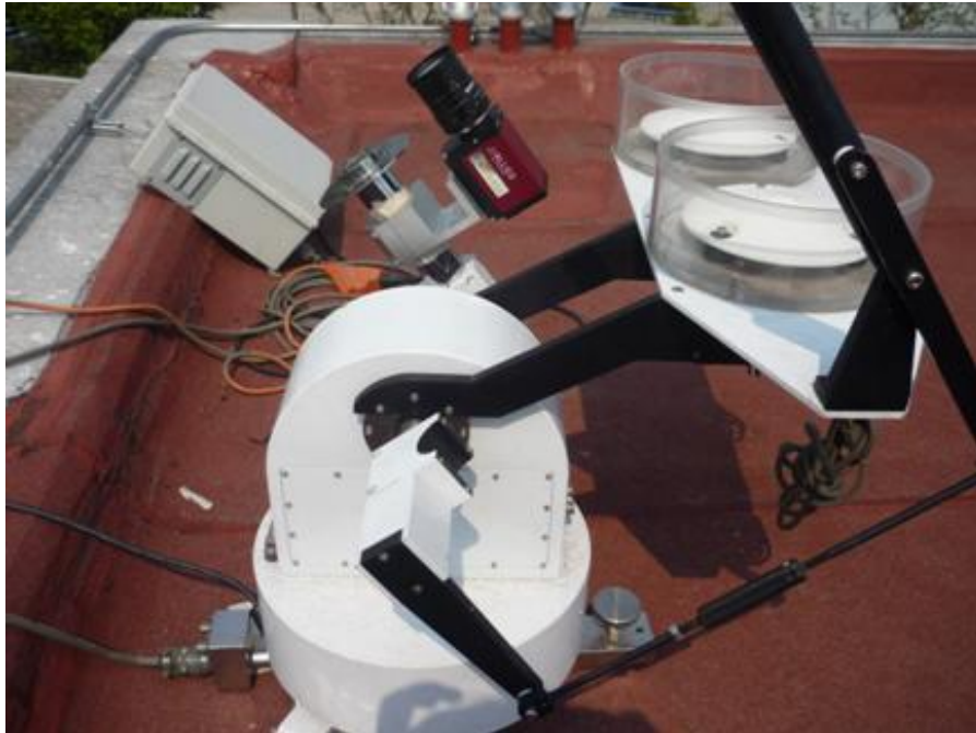
Fig. 2.2. Cámara montada en el pirheliómetro y la estación meteorológica.
