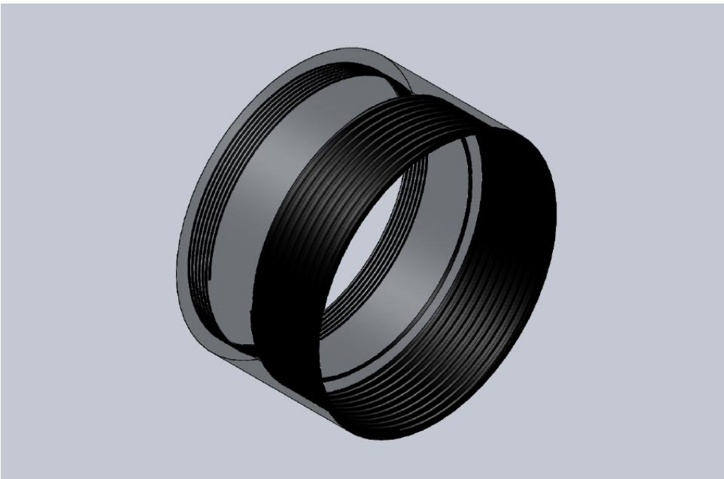
Fig. 4.2. Soporte para lentes y filtros.
