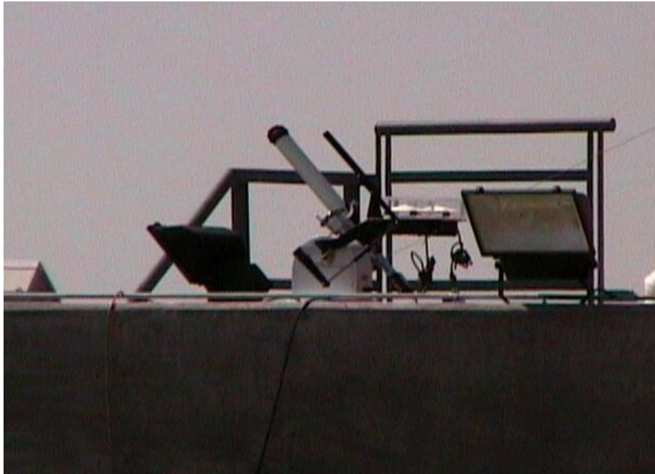
Fig. 2.8. Sensor CCD acoplado a telescopio y montado en el robot.
