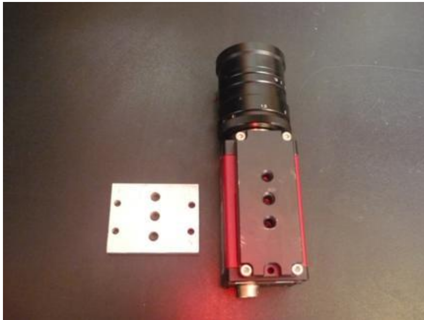
Fig. 2.3. Placa para montar la cámara al sistema de seguimiento solar.
