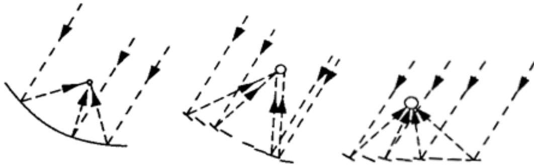
Fig. 1.1. Concentrador parabólico, reflectores de tipo Fresnel, helióstatos con receptor central (tomado de Duffie, 1991).
