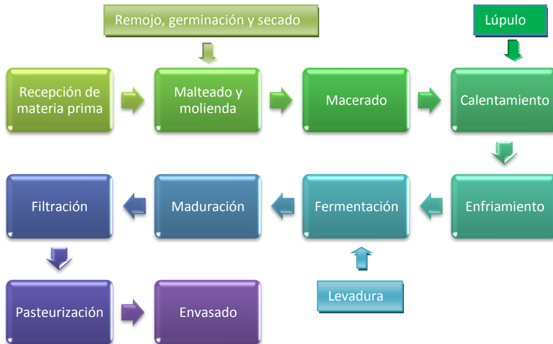
Figura 3.1. Diagrama del proceso de elaboración de cerveza
