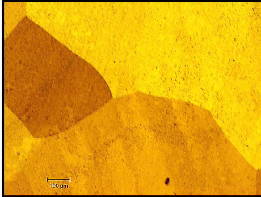
Figura 30. Muestra en Austenita Base sin elementos microaleantes. (5x)
