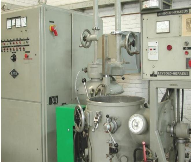
Figura 21 Horno de Inducción con fuente de radio-frecuencia
