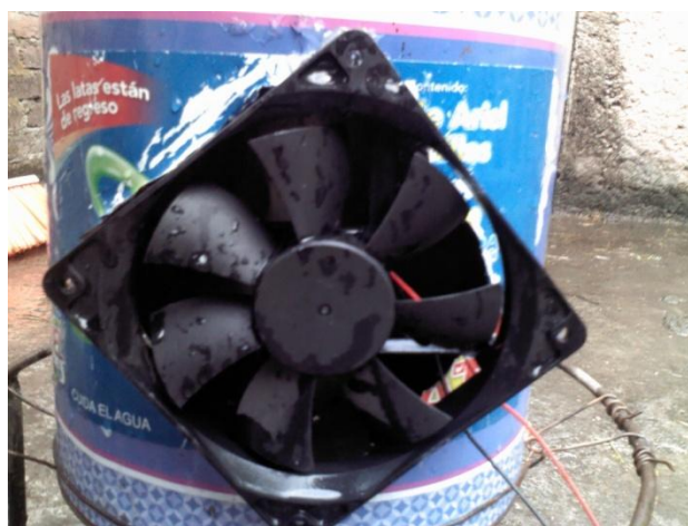
Figura 6.10 ventilador que proporciona un flujo de aire constante a la columna de absorción.
