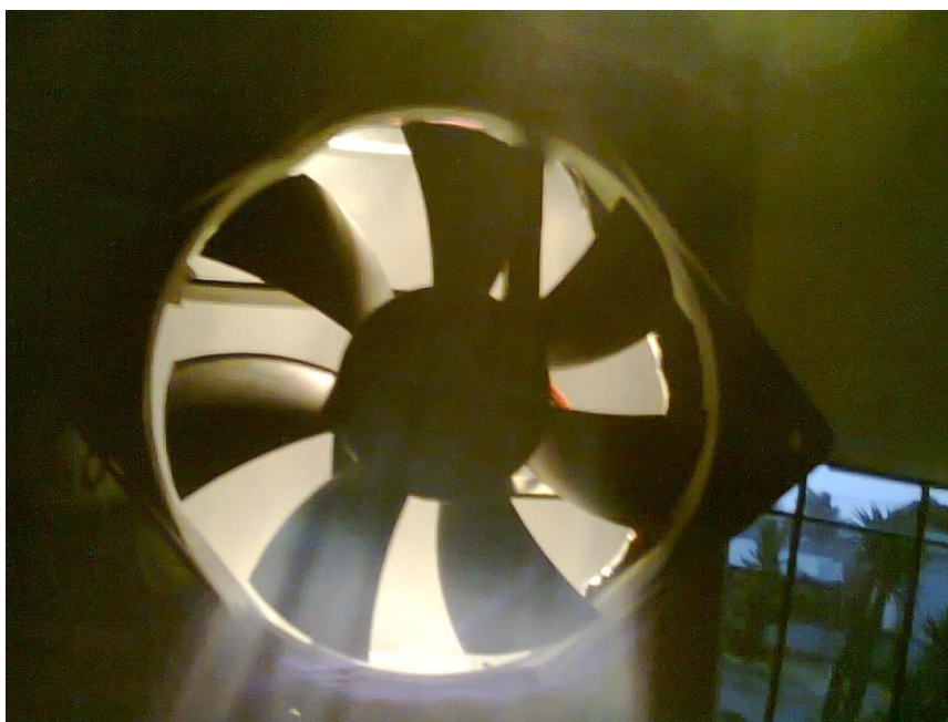
Figura 6.6 “Ventilador instalado en la parte inferior de la columna”
