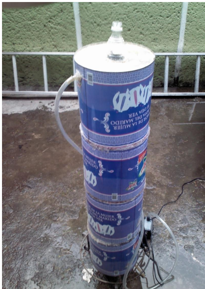
Figura 6.9 Columna de absorción instalada en la azotea de un hogar
