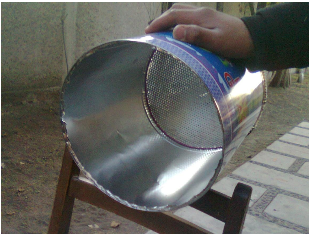
Figura 6.2 interior de la columna de absorción.
