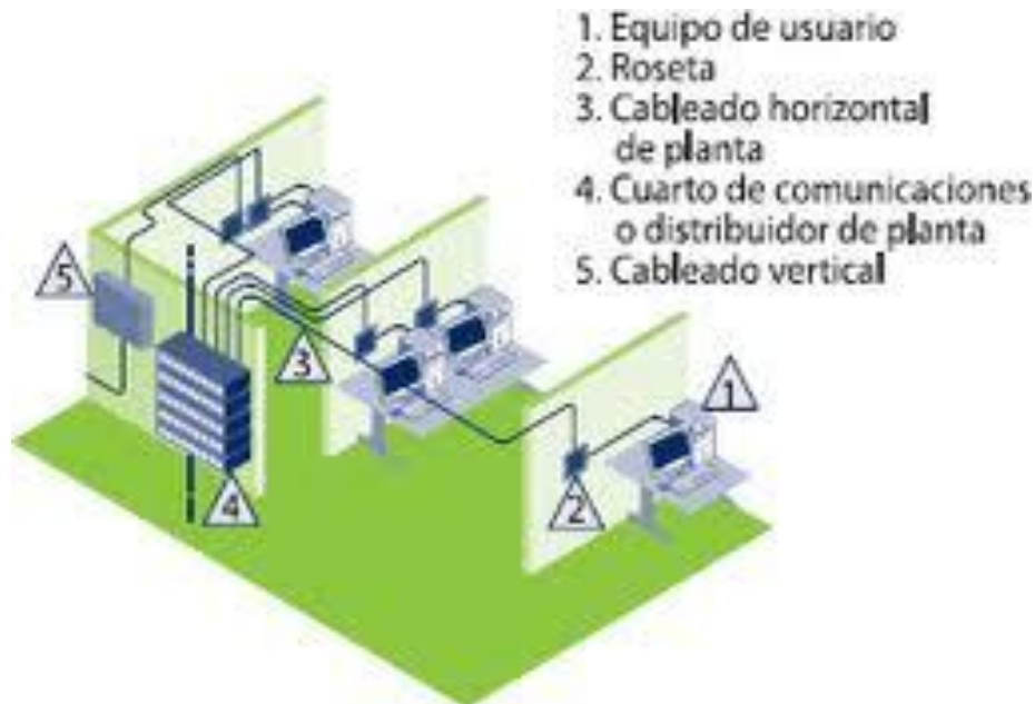
Figura 4.1.4 Componentes del cableado estructurado
