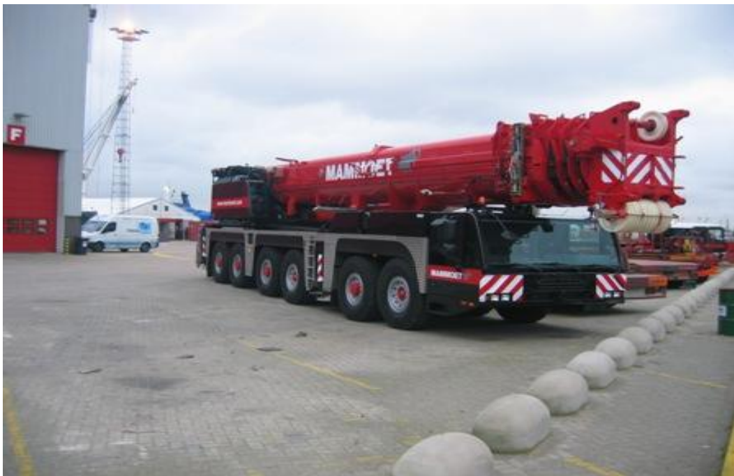
Ilustración 81. “Grúa Terex de 350 toneladas”
