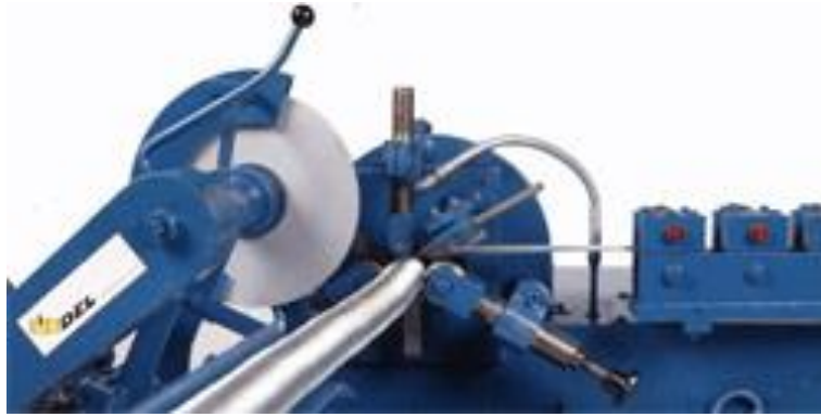
Ilustración 14. “Engargoladora de ductos”
