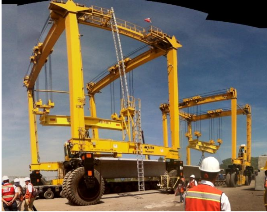
Ilustración 72. “Grua de portico cargando modular”
