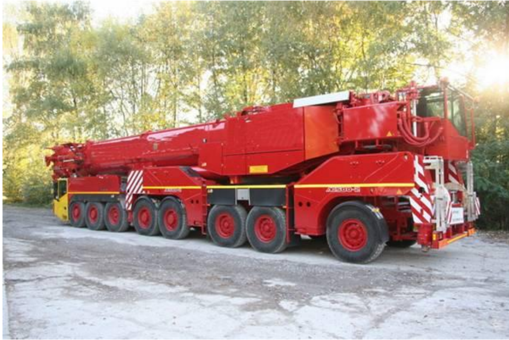
Ilustración 80. “Grúa Terex de 500 toneladas”
