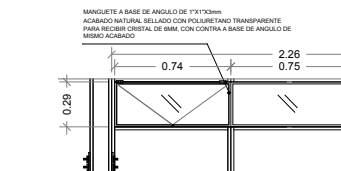
ALZADO VENTANAS EN FACHADA NORTE DEL A
