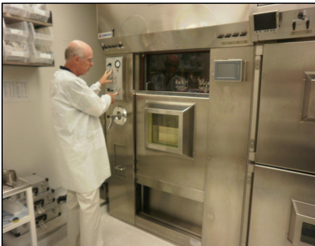
Fig. 3.3 Módulo de síntesis que se encuentra dentro de la “celda caliente”.
