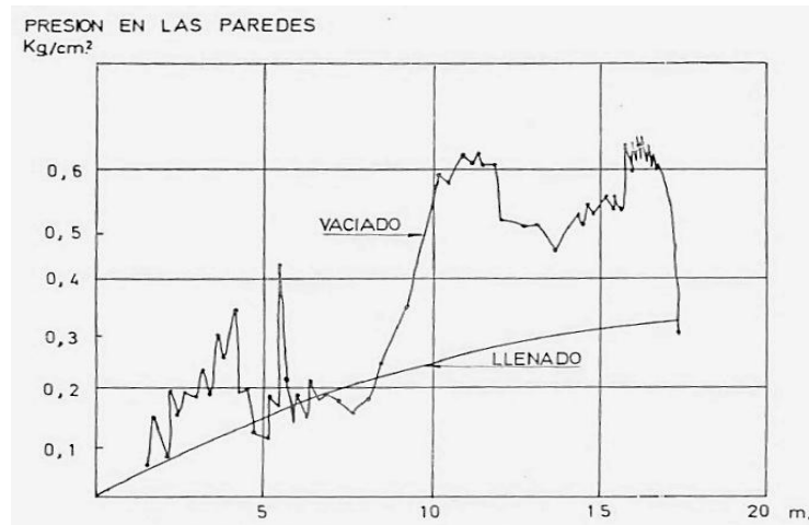
Fig. 3.9 Presiones sobre las paredes de un silo de concreto armado durante el llenado y vaciado. Tomado de Ref.4 “SILOS”
