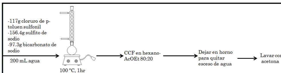
Figura 9. Diagrama de flujo para la síntesis del p-toluensulfinato de sodio.
