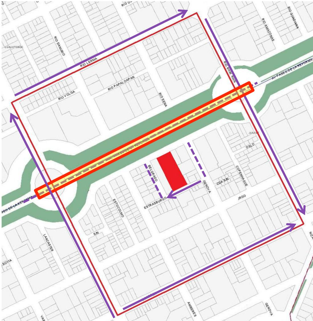
Por el Paseo de la Reforma circulan entre 3,500 y 4,500 vehículos por hora / sentido, tiene 10 carriles vehiculares con un ancho de 3.60 metros por carril.
