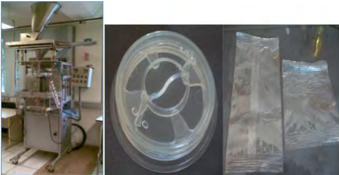
Ilustración 16. Maquina de Formado, Llenado y Sellado utilizada para el proyecto del lado izquierdo, la cual crea las bolsas de cómo las de la figura del lado derecho la cual será unida con los dispositivos de la figura del centro
