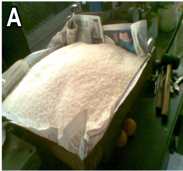
Ilustración 18. A) PLA natural antes de secar, B) Pruebas con PLA con distintos moldes del CDMIT para conocer propiedades
