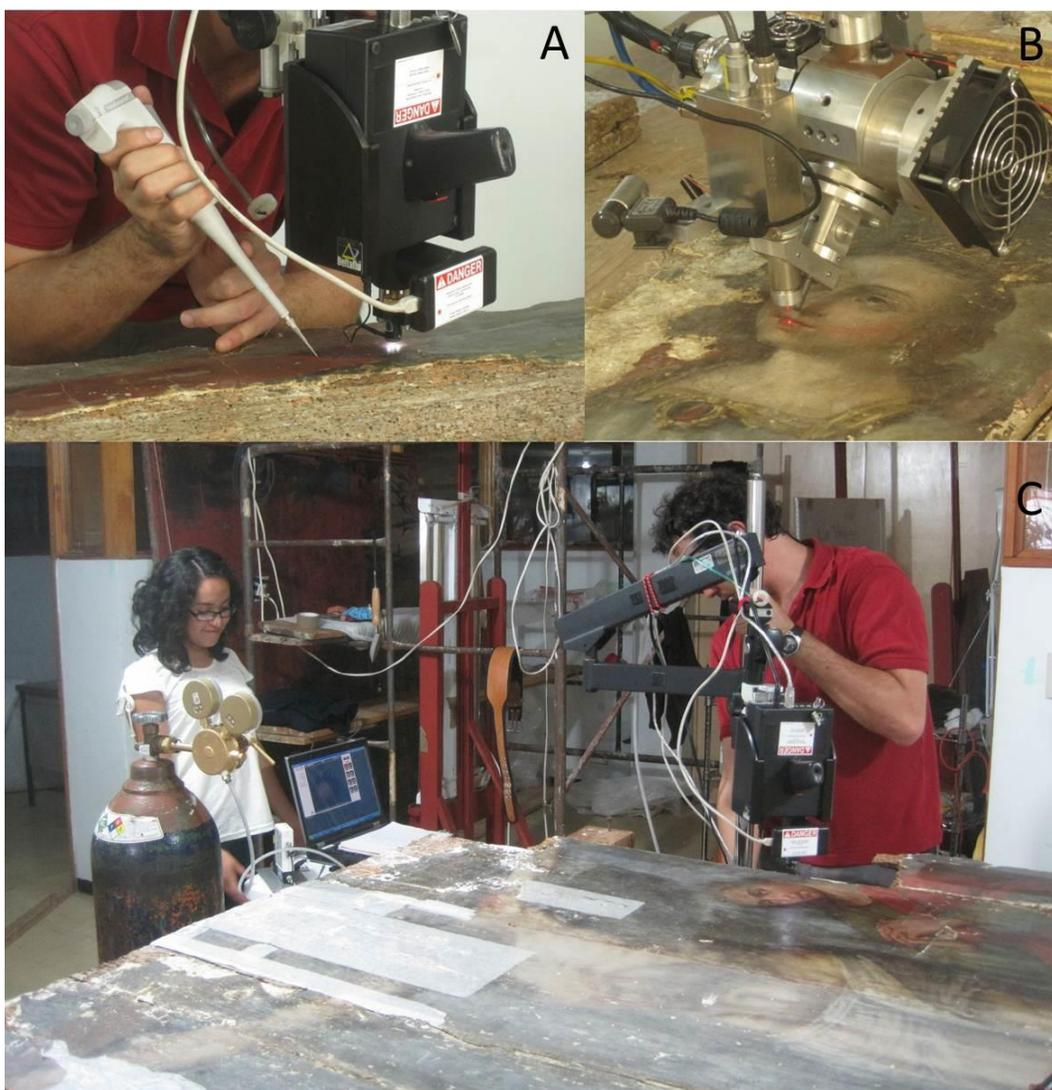
**FIGURA 4.5.** (A) Aplicación con una micro pipeta del coloide con  $\text{KNO}_3$  sobre la superficie de la tabla para su estudio con SERS. (B) Análisis con fluorescencia de Rayos X con el equipo portátil SANDRA. (C) Imagen del proceso de adquisición de espectros Raman, Raman con He y SERS de una de las tablas del ex convento de San Fco. Tepeyanco.
