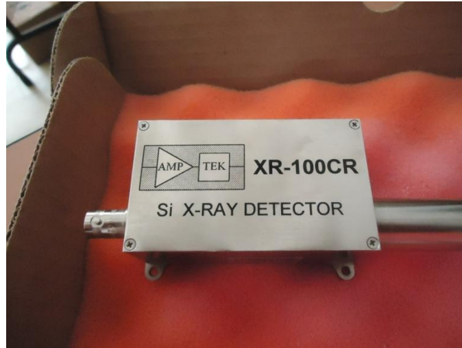
Figura 2.3.2 Preamplificador para un modelo de detector de Silicio XR-100CR.
