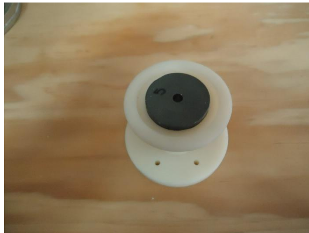
Figura A.1.5 Colimador de 5mm acoplado con pieza de Nylon
