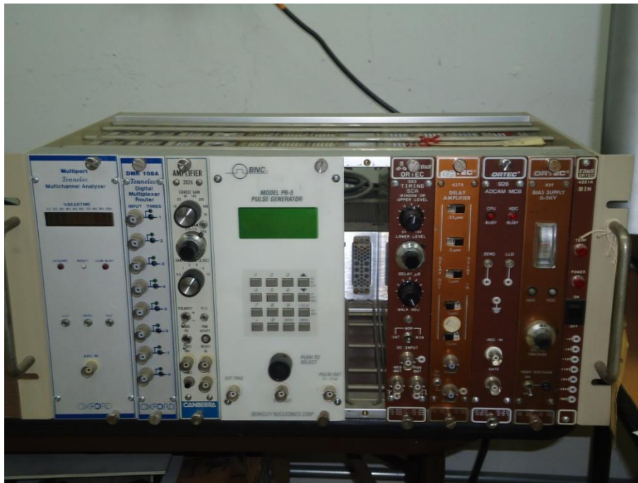
Figura 2.3.1 Gabinete NIM – BIN con módulos de electrónica nuclear.
