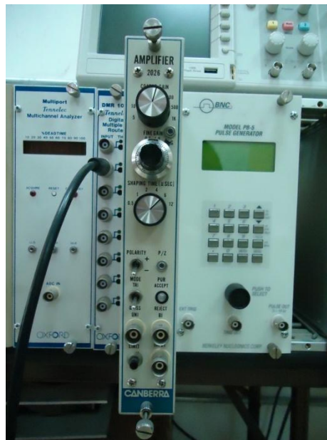
Figura 2.3.7 Módulo amplificador bajo normas NIM (Canberra 2026).
