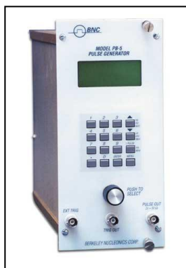
Figura 3.2.1 Generador de pulsos, módulo NIM, Modelo PB-5, de Berkeley Nucleonics Corp.
