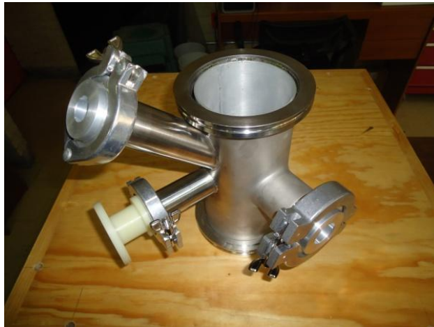
Figura A.1.12 Cámara inicial de coincidencias ensamblada con acopladores de detectores y de tubo de rayos X
