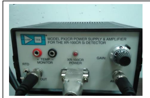
Figura 3.1.10 Amplificador y fuente de poder del detector Si-PIN.
