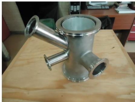
Figura A.1.1 Cámara de acero inoxidable destinada para experimento en coincidencias.
