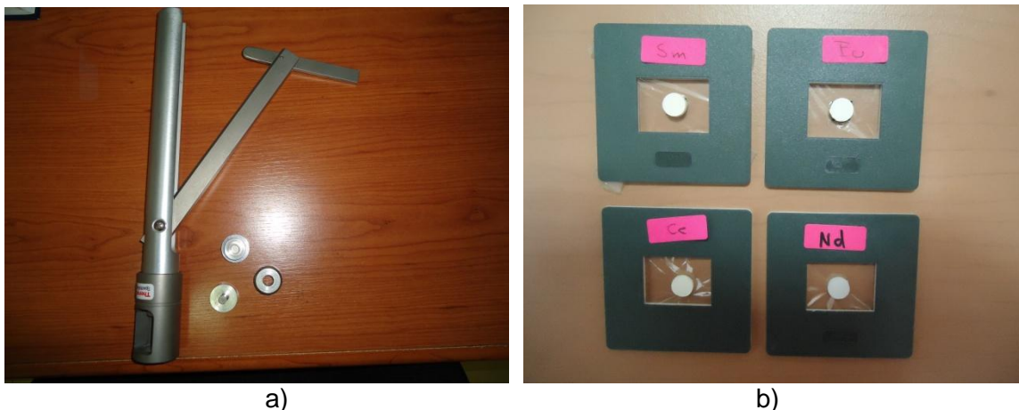
Figura 3.1.14 Preparación de muestras a) Empastillador de prensa manual. b) Pastillas sólidas de compuestos químicos de los elementos de interés.
