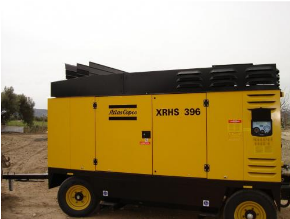
Figura 1.1 Compresor de aire Atlas Copco.
