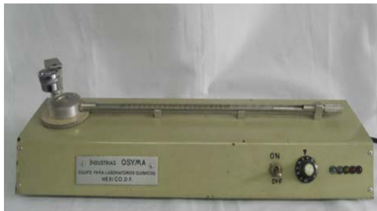
Fig. 3.3: Aparato para determinar el punto de fusión de los AGAS.
