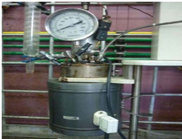
Fig. 3.2. Reactor Parr utilizado para la realización de la reacción de aminólisis.
