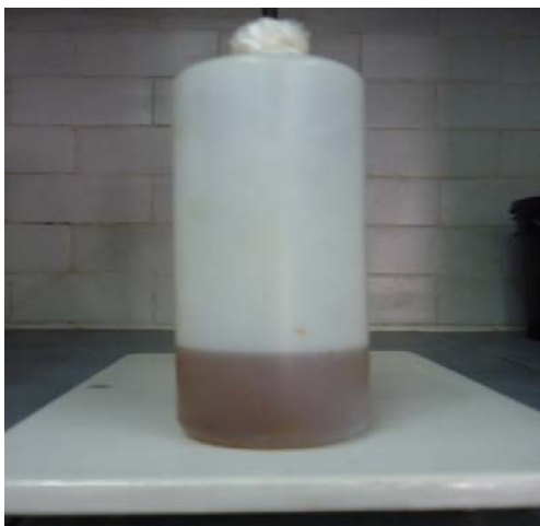
Fig. 4.10. Producto de la reacción de aminólisis de EMAS, usando el reactor PARR a una T=200 °C, 5 h de reacción y 1:1.05 (EMAS: DMAPA).
