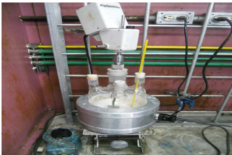
Fig. 3.4 Sistema de reacción (carboxialquilación de la amidoamina).
