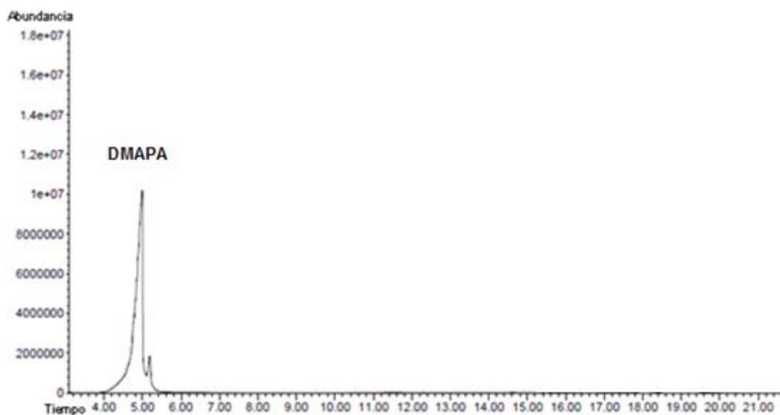
Fig. 4.4. Cromatograma de DMAPA (N-N dimetilaminopropilamina).
