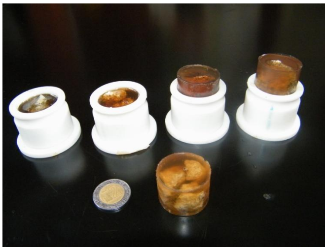
Figura 5. 1 Muestras encapsuladas en resina, 2012.
