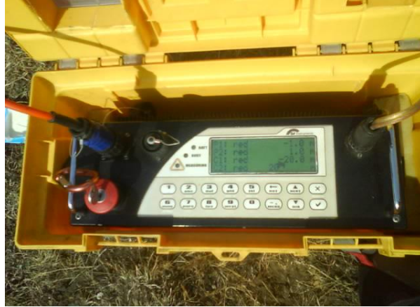
Figura 4. 25 Imagen del equipo utilizado para las lecturas de Resistividad, Ares.
