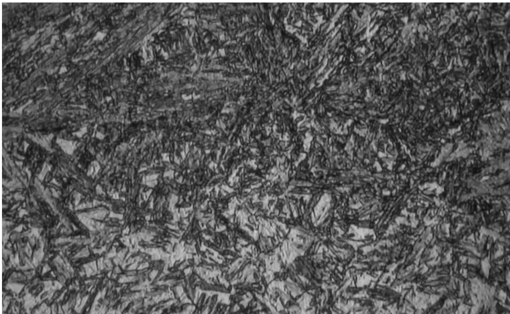
Figura 23.- Micrografía de la estructura de la probeta 7 de impacto, donde se puede observar la presencia de Martensita revenida donde se aprecia la presencia de Austenita retenida y pequeños carburos de cromo. Tomada a 600X.
