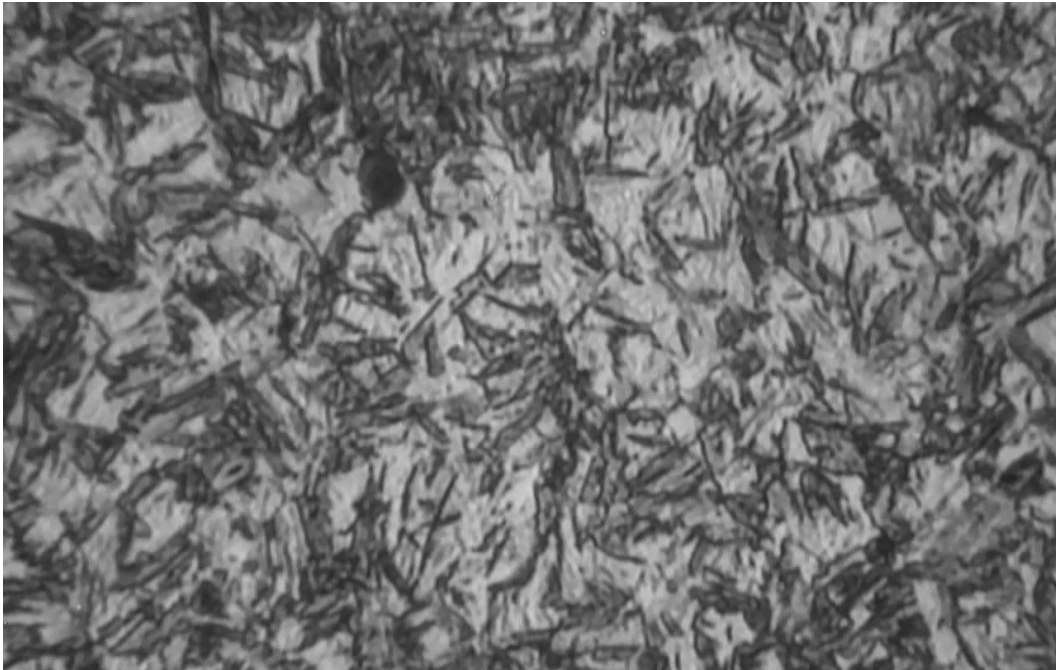
Figura 24.- Micrografía de la estructura de la probeta 7 de impacto, donde se puede observar con mayor claridad la presencia de Martensita revenida blanca y oscura con la presencia de pequeños carburos de cromo en el interior de la Martensita. Tomada a 800X.
