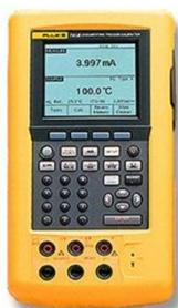
Figura 5.26 Calibrador de procesos Fluke 744. Fuente: [http://articulo.mercadolibre.com.mx/MLM-416943964-calibrador-de-procesos-marca-fluke-744-daa-\\_JM?redirectedFromParent=MLM413491991](http://articulo.mercadolibre.com.mx/MLM-416943964-calibrador-de-procesos-marca-fluke-744-daa-_JM?redirectedFromParent=MLM413491991)
