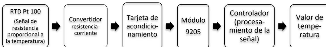
Figura 5.25 Etapas en la medición de temperatura
