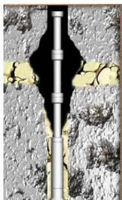
Fig. 2. 16 Hinchamiento y derrumbe
