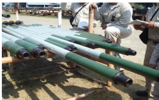
Fig. 2. 7 Lastrabarrena corto, Patio de tubería, Activo Samaria-Luna en Tabasco.
