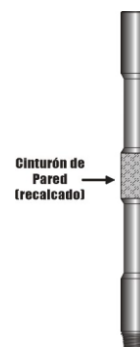
Fig. 2. 14 Identificación de la tubería pesada (recalcado)
