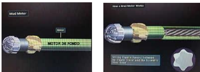
Fig. 2. 32 Motor de fondo y su funcionamiento.
