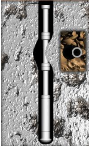
Fig. 2. 20 Atrapamiento lateral debido a una "pata de perro"
