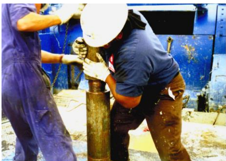
Fig. 2. 4 Forma en la que se enrosca la tubería de perforación, se puede observar la conexión y el cuerpo de la tubería.
