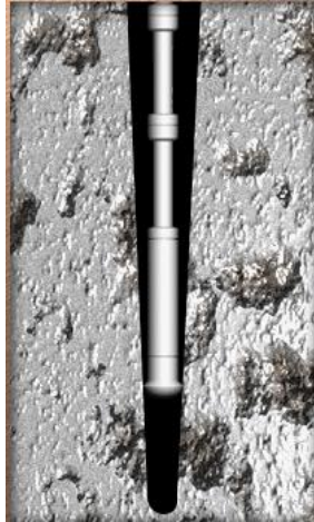
Fig. 2. 21 Atrapamiento ocasionado por un cambio de barrena la cual queda atrapada en agujeros de diámetro muy reducido.
