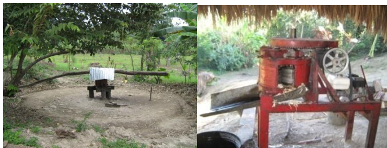
Figura 27. Trapiche movido por animales para extraer jugo de caña y un molino de motor de caña.
