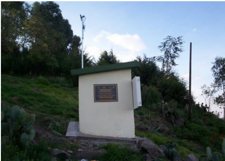
Figura 12 Estación de la red del Valle de México y sismógrafo Reftek.
