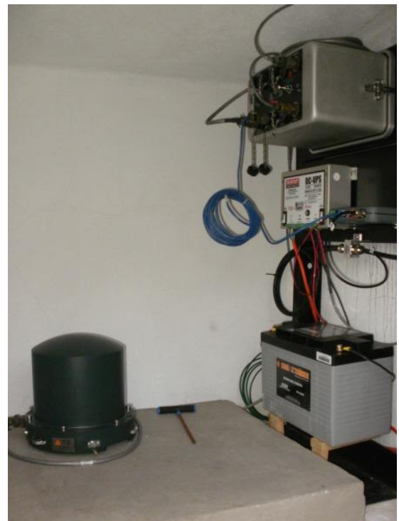
Figura 12 Estación de la red del Valle de México y sismógrafo Reftek.
