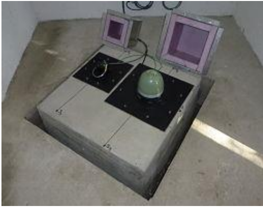
Figura 17 Cuarto de Sensores con sus protecciones electromagnéticas y térmicas.
