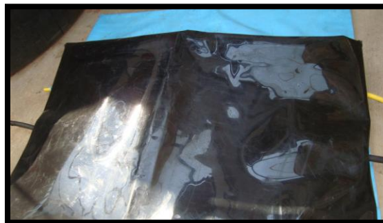
Figura 4. 6 Bolsas de almacenamiento del biogás
