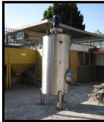
Figura 4. 4 Reactor acidogénico de 1000 L
