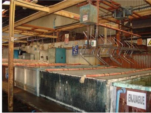
**Figura 1.11 Tinas de Acabado (Fotografías de la empresa)**
